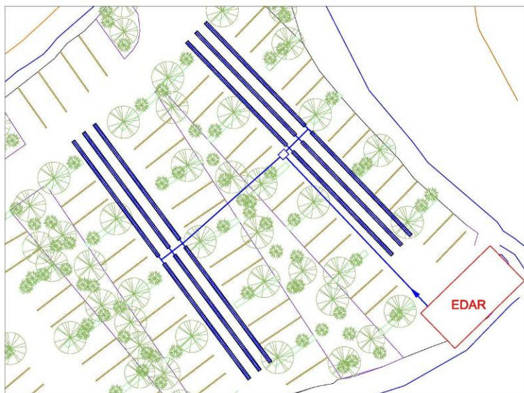
Zanjas filtrantes para el vertido de las aguas residuales depuradas.
