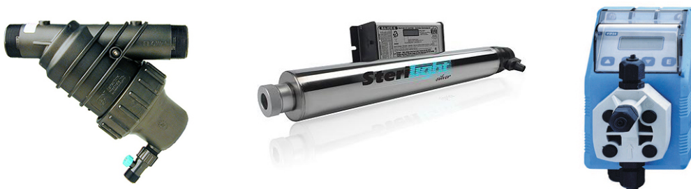
Ejemplo de etapas del tratamiento terciario. Filtro de malla, desinfección ultravioleta y dosificador de cloro.
