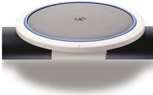
Difusores de membrana en forma de disco para una aireación de burbuja fina fiable y energéticamente más eficiente, en balsas de agua residual de plantas de tratamiento. Idóneos para sistemas de aireación continua, así como en aireación intermitente, por ejemplo, para la eliminación de nutrientes y procesos SBR.
